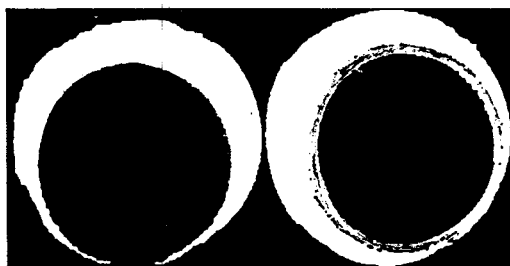
그림 33. Methanol에 담긴 3 cm 지름의 PMMA의 NMR Image(30 ^{\circ}\text{C} ). 왼쪽은 담근 직후에, 그리고 오른쪽은 48시간 이후에 측정된 것이다. 밖의 흰 부분이 순수 methanol이며, 안의 검은 부분이 PMMA에 해당되며 고체 상태이기 때문에 signal이 0이다. 사이의 옅은 부분이 PMMA 내부의 methanol이다(오른쪽 그림).
