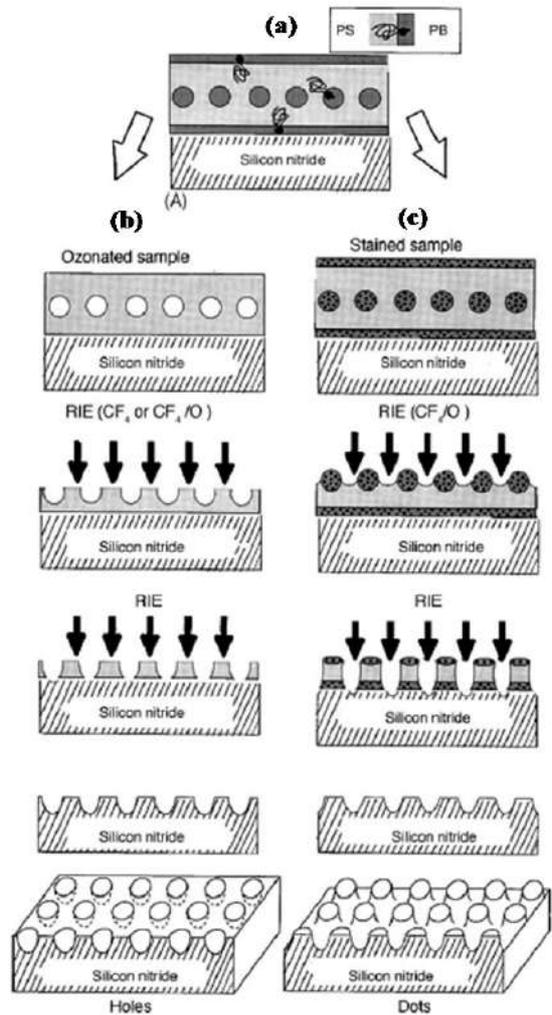
그림 6. 블록공중합체 리소그래피의 모식도. PS-*b*-PB 블록공중합체의 나노구조체를 형성한 후 선택적인 에칭 방법을 이용하여 기질 위에 패턴을 전사하는 과정을 보여줌.
