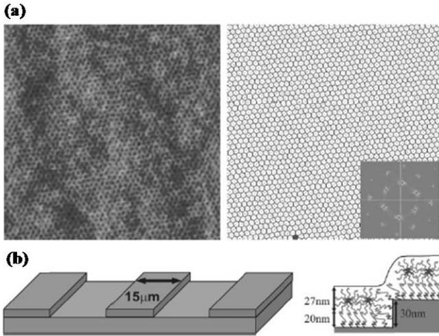
**그림 3.** (a) 왼쪽은 PS-*b*-P2VP 블록공중합체의 구형 나노구조체의 이차원 배열을 보여주는 AFM 이미지며, 오른쪽은 Voronoi 분석 결과를 보여주고 있음. (b) 광식각에 의해 만들어진 마이크로 주기의 패턴과 패턴 위에 구형 구조의 모습.
