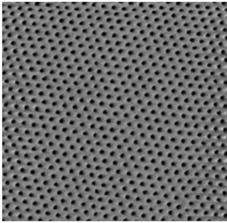
**그림 1.** PS-*b*-PEO 블록공중합체 필름의 AFM 이미지(2  $\mu\text{m} \times 2 \mu\text{m}$ ): 벤젠과 물의 증기에 의해 어닐링된 수직으로 정렬된 실린더 나노구조체의 모습.
