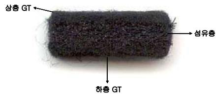
그림 9. 지오텍스타일 보강 복합재료.
